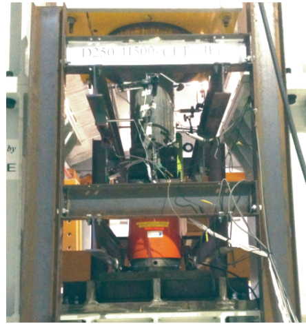
写真 3 短柱圧縮試験の状況
