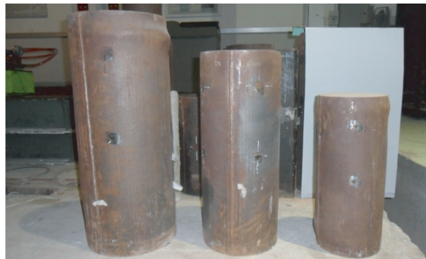
写真 4 CFT 試験体 (試験終了時)
