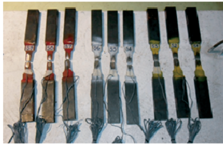
写真 2 鋼管の引張試験片
