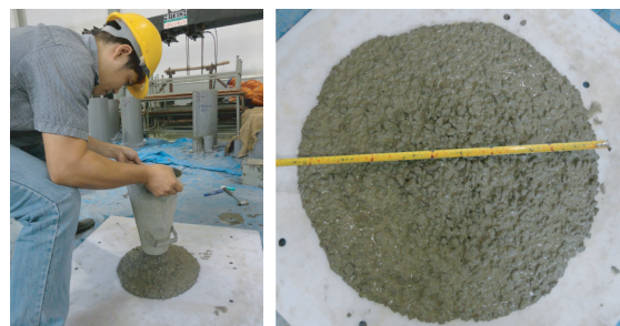
写真 1 スランプフロー試験の状況
